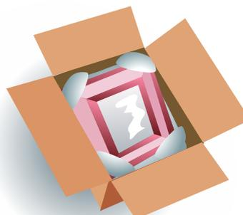
En las siguientes imágenes se muestra el embalaje que cumple con las tres funciones, de inmovilizar, amortiguar y aislar de las paredes de la caja de cartón.
