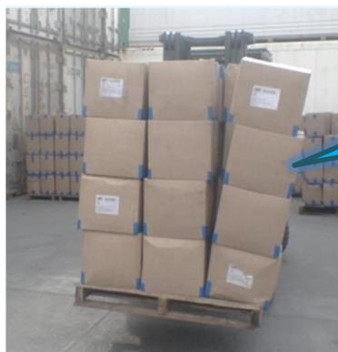
Deformación de cajas por exceso de presión vertical.
